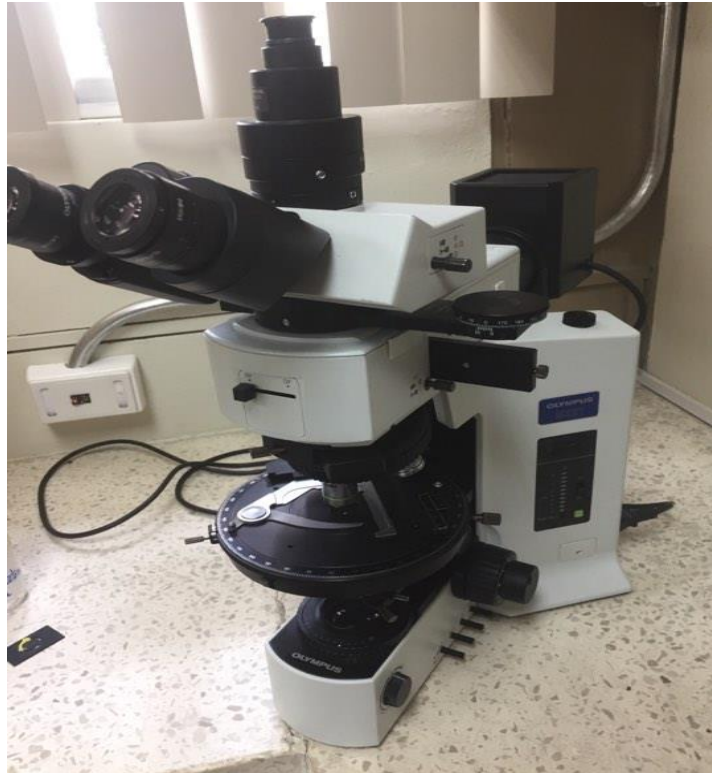
Fig. 2.6 Microscopio de opacos utilizado para examinar las láminas pulidas.
