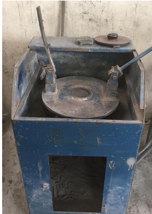
Fig. 2.4 Pulverizador planetario marca Fritsch utilizado en la fase de preparación
