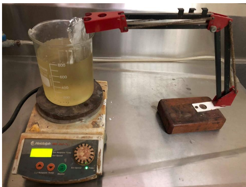
Fig. 2.9 Sistema de cementación de Au con Al y NaF. Fuente: Legemesa, 2018
