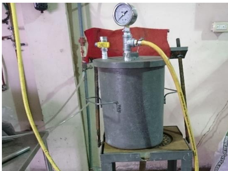
Fig. 2.19 Filtrador de muestras con aire comprimido. Fuente: Legemesa, 2018
