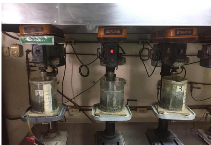
Fig. 2.18 Agitadores mecánicos para lixiviación. Fuente: Legemesa,2018
