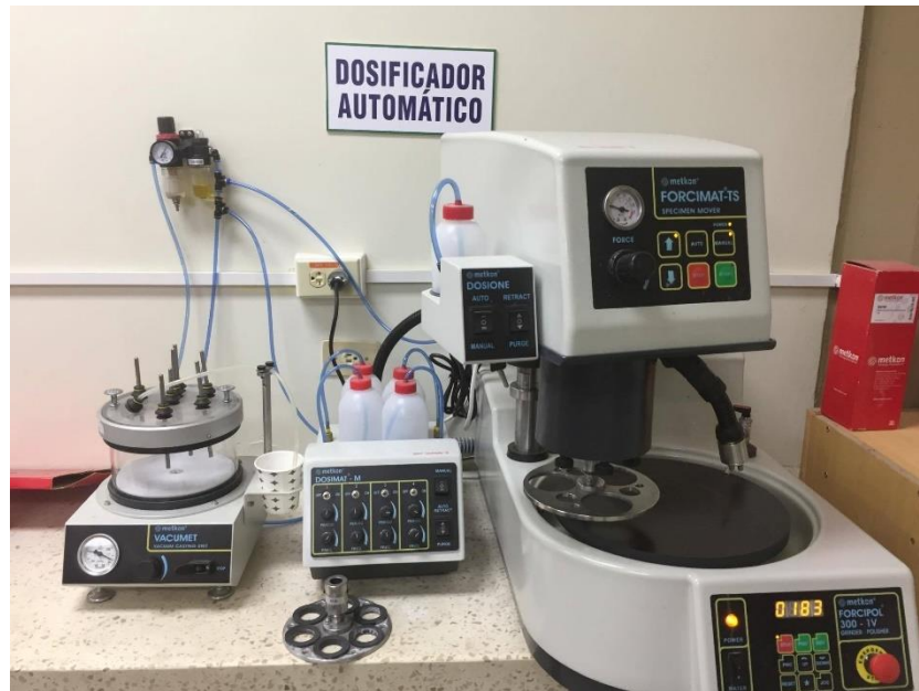
Fig. 2.5 Pulidora marca Metkon FORCIPOL utilizada en la fabricación de las láminas pulidas .
