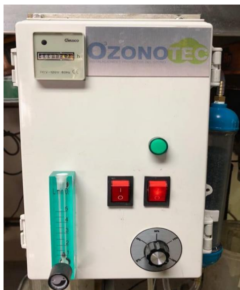
Fig. 2.20 Generador de Ozono.
