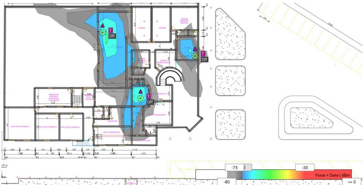
Figura 2.5 Cobertura Actual Edificio Planta Baja
