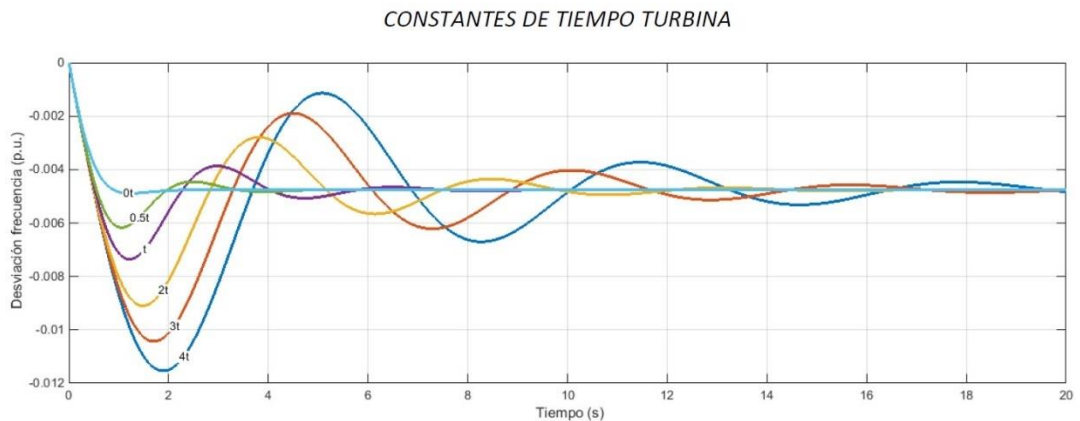
Figura 2.6 Respuestas de frecuencia para valores diferentes de constantes de tiempo
