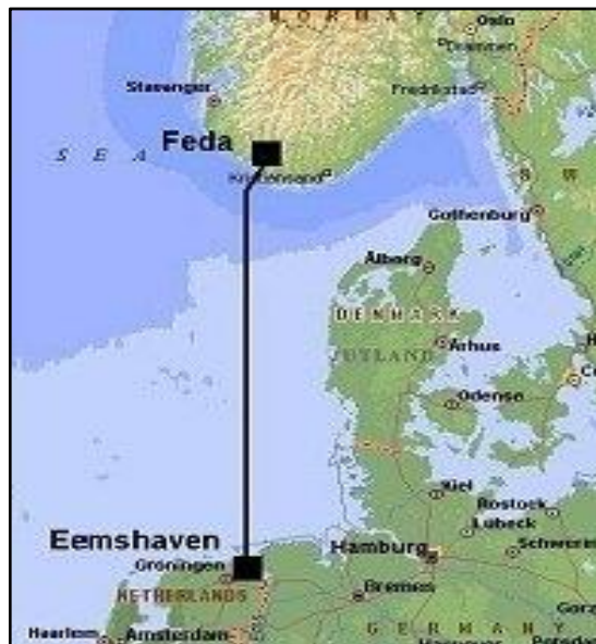
Figura 1.9 Transmisión submarina con HVDC.
