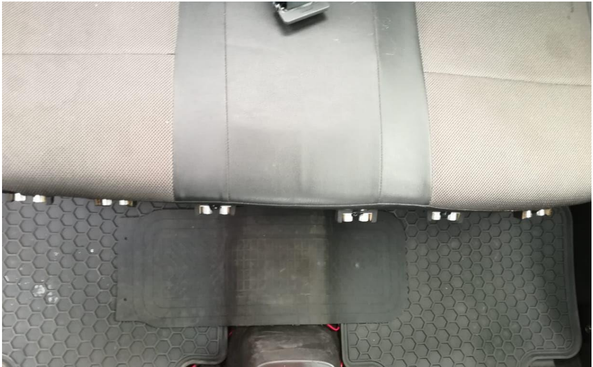
Figura 4.3. Sensores ultrasónicos ubicados en el asiento trasero.
