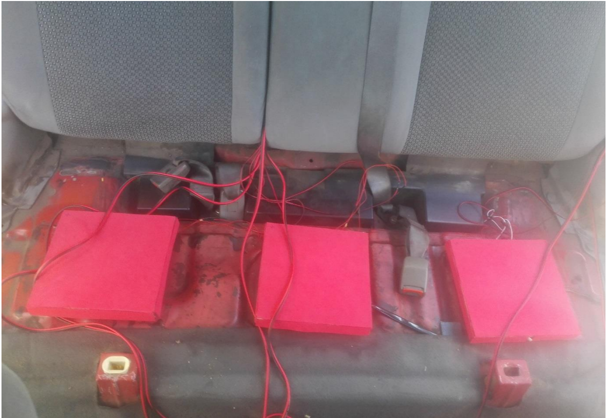
Figura 4.1. Celdas de carga ubicados en el interior del asiento trasero.
