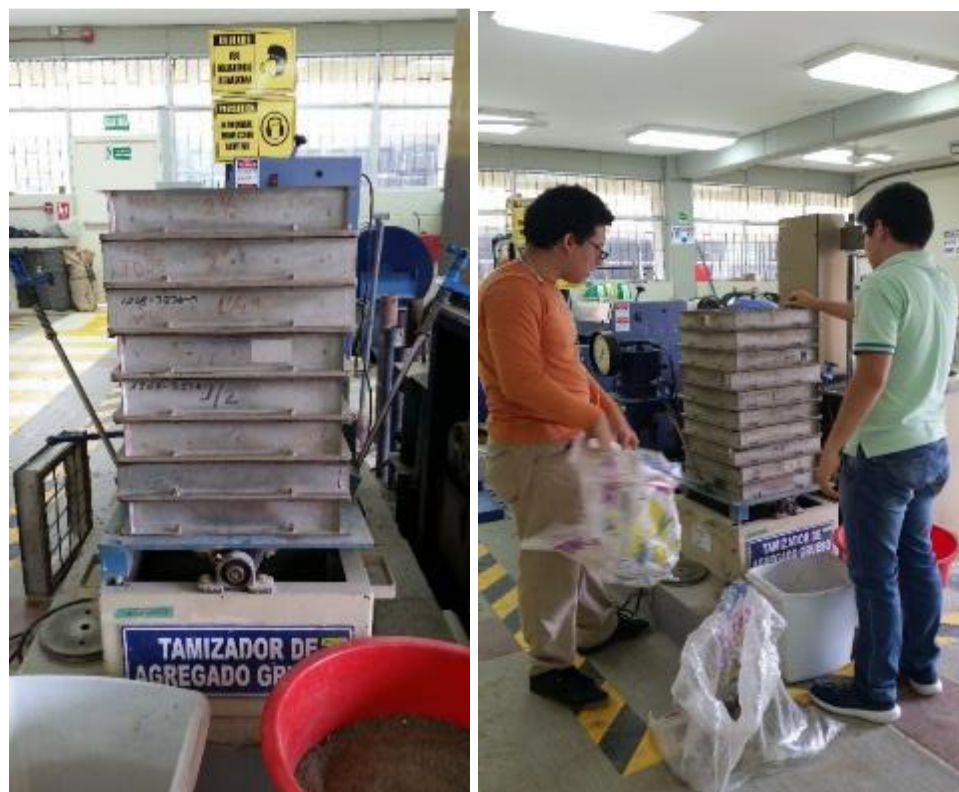
Figura 0.28. Tamizado de muestras para análisis granulométrico.
