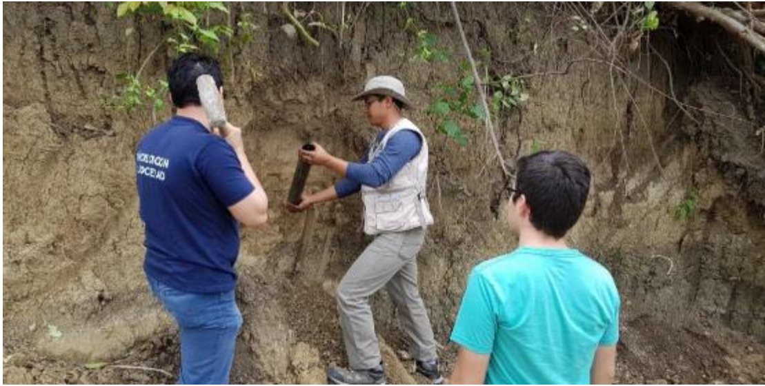
Figura 0.23. Hincada de tubo shelby en talud
