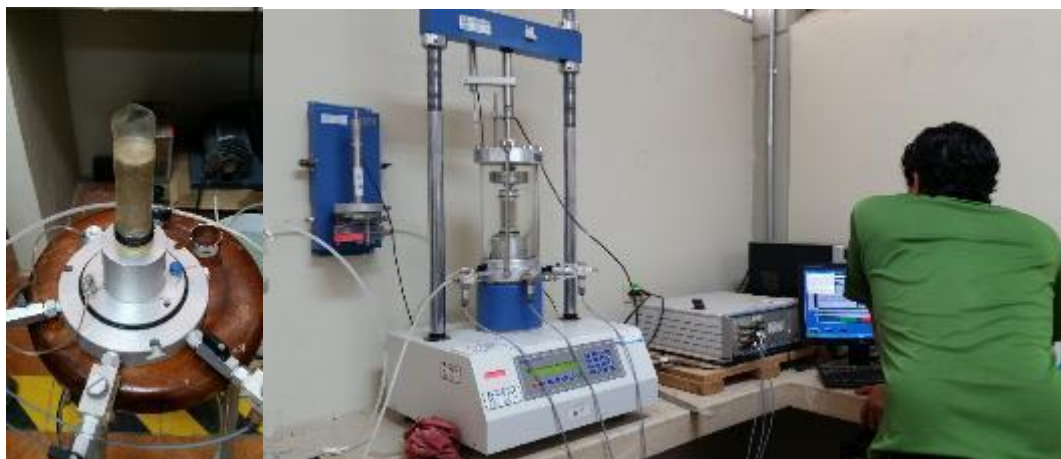
Figura 0.6. de izq. a der. Se muestra Probeta cilíndrica y ensayo triaxial en la cámara de confinamiento.
