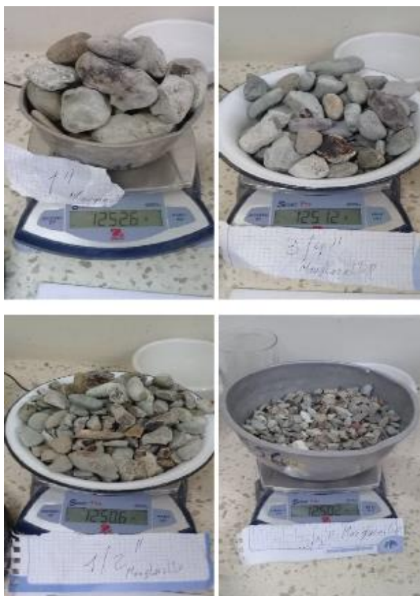
Figura 0.41. Peso de muestras secas, para ingresar a máquina de abrasión de los Ángeles.
