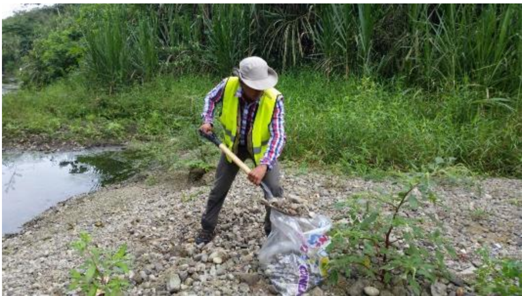
Figura 0.17. Toma de muestras de grava en la superficie para prueba de abrasión.
