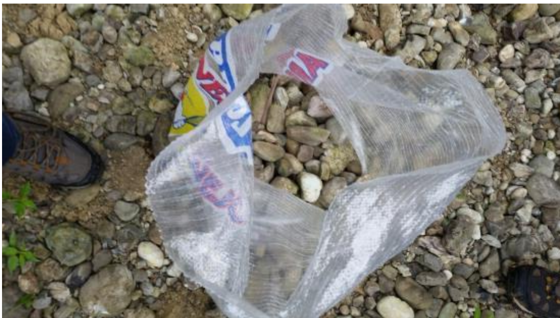
Figura 0.26. Muestra de aluvial para prueba de abrasión.
