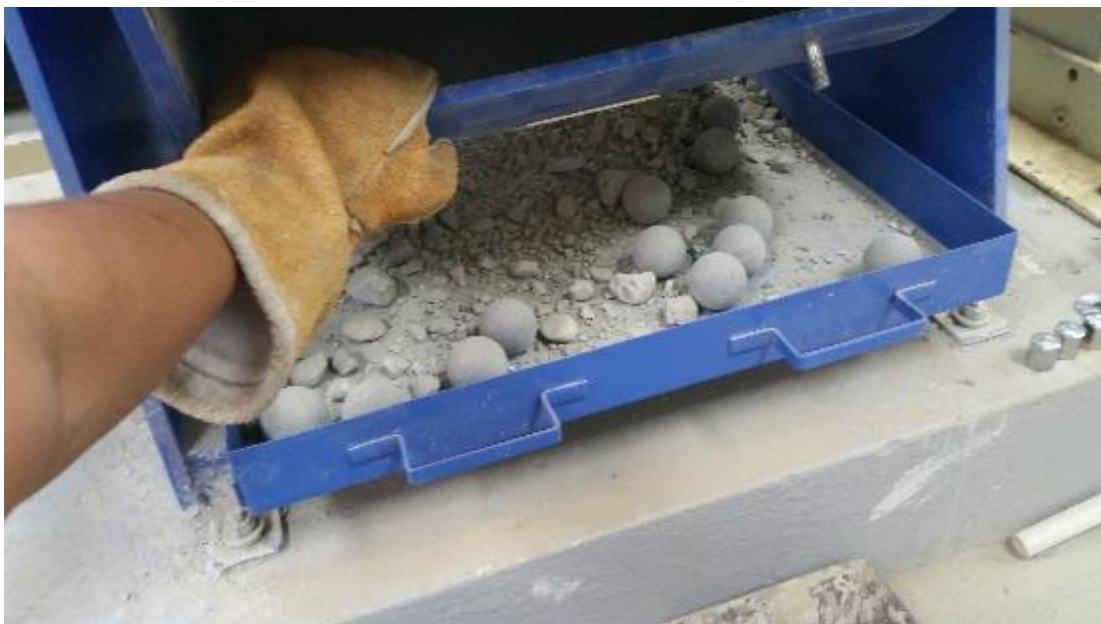
Figura 0.42. Extracción de material luego de la prueba de los Ángeles.
