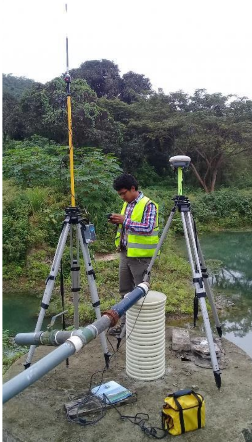
Figura 0.3. Calibración en RTK del equipo de GPS.
