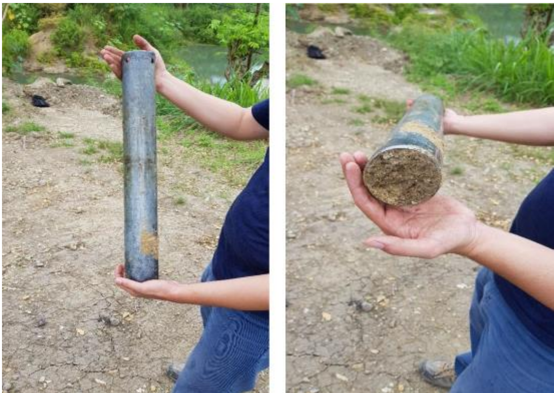
Figura 0.24. Muestra extraída en talud
