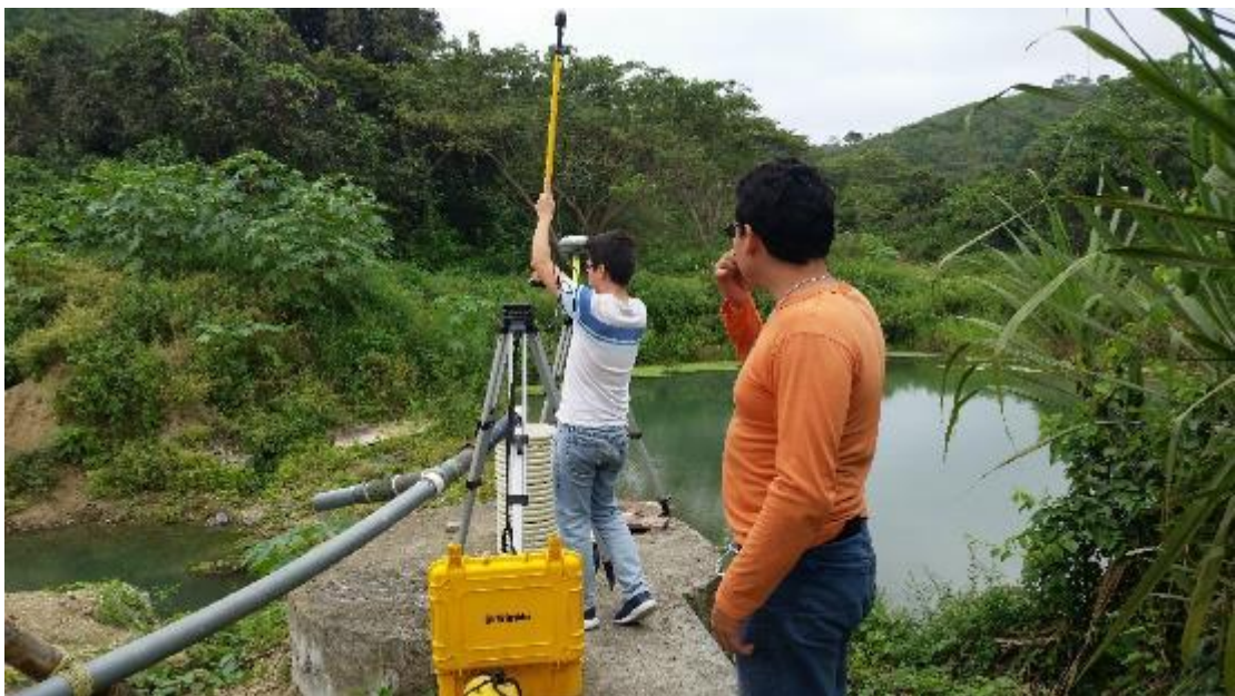
Figura 0.2. Instalación del trípode con la antena receptora.
