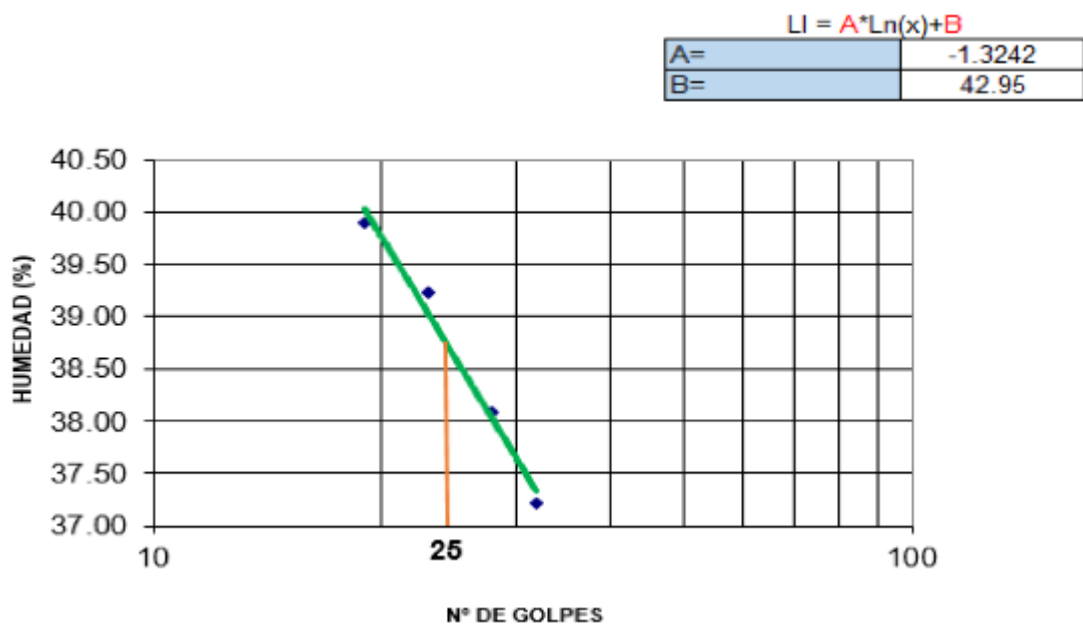
Figura 0.33. Limite líquido para muestra de talud izquierdo, P1 en la tabla XII.
