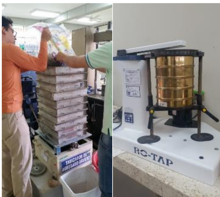
Figura 0.1 Granulometría. Tamices agregado grueso (Izquierda) y fino (Derecha).
