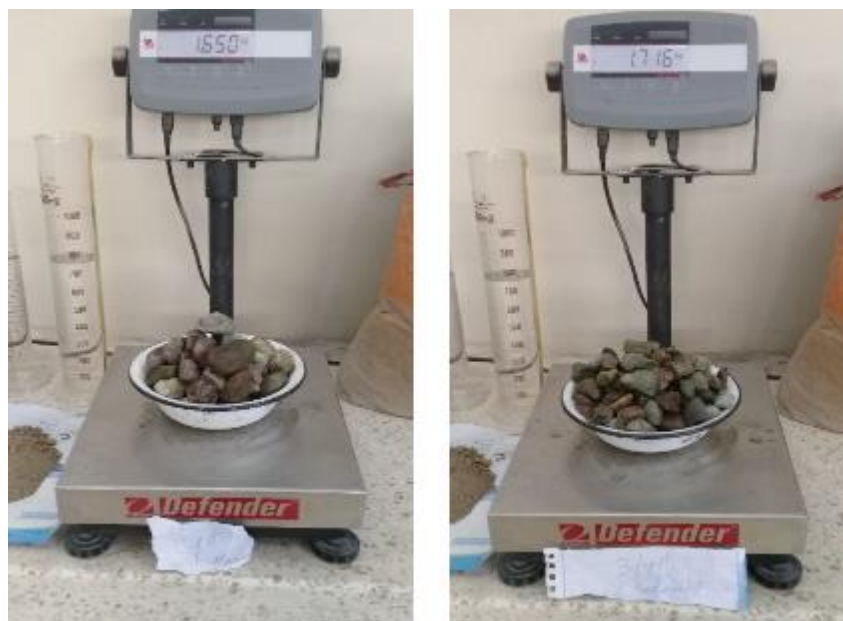
Figura 0.39. Peso de muestras tamizadas, antes de lavar.
