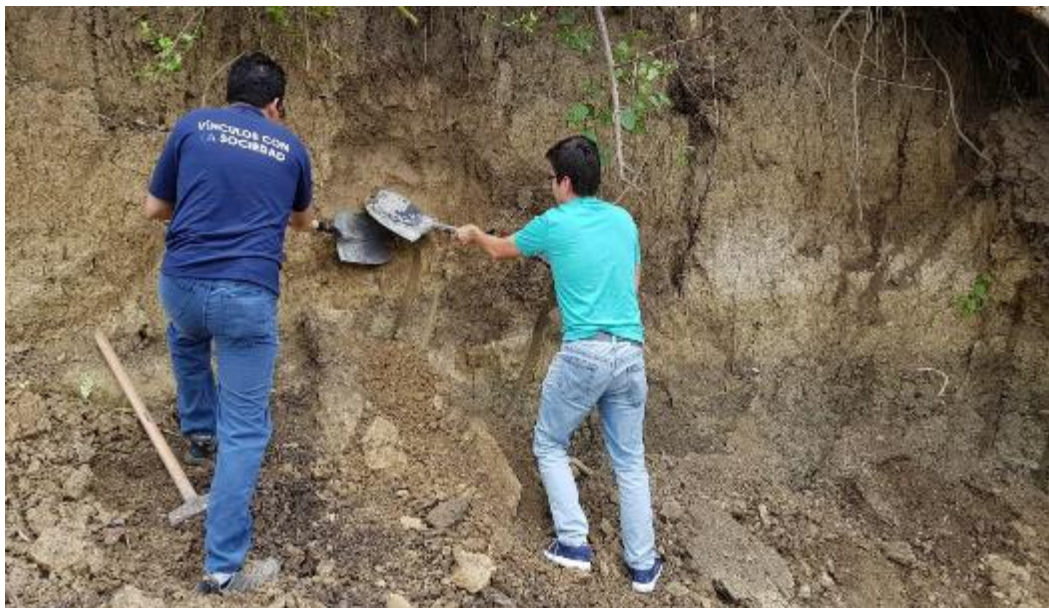
Figura 0.22. Limpieza de terreno en talud para toma de muestra con tubo shelby.
