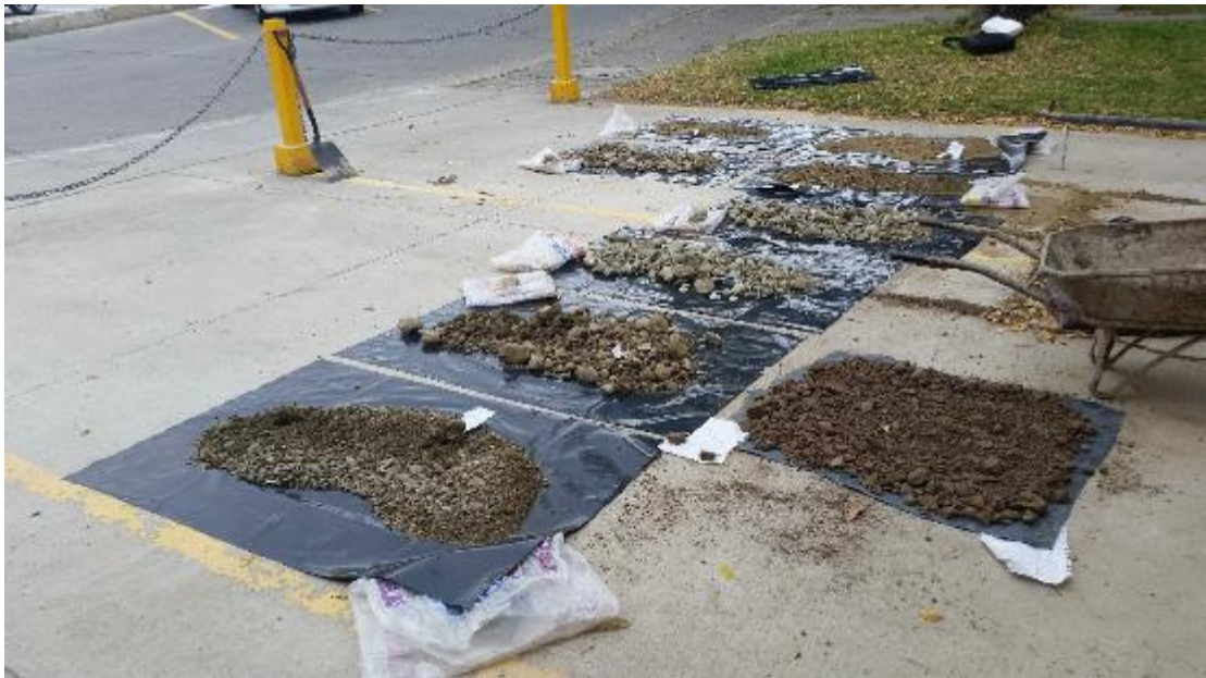
Figura 0.27. Secado de muestras de suelo para ensayos geotécnicos.
