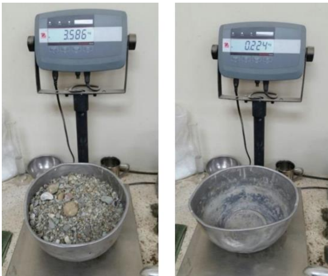
Figura 0.43. Peso final de muestra más recipiente, peso de recipiente
