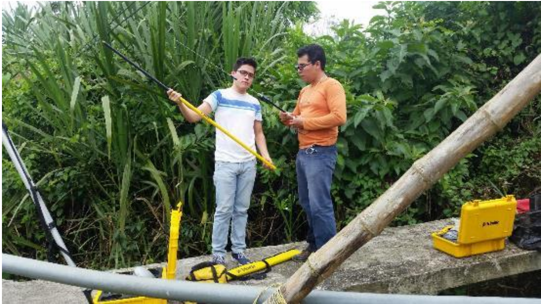
Figura 0.1. Ensamblaje de los equipos del GPS diferencial.
