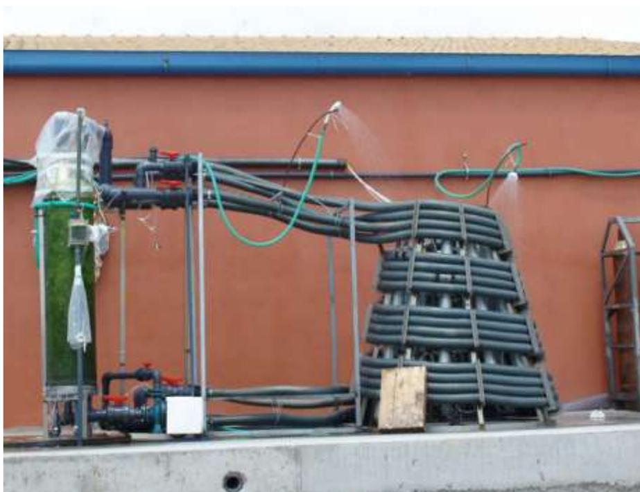
**Ilustración 2.5 Fotobiorreactor tubular helicoidal (Briassoulis et al., 2010)**
