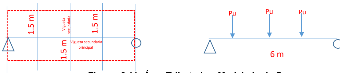
Figura 2.11: Área Tributaria y Modelado de Cargas
