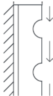
Figura 2.80: Falla Por Fractura
