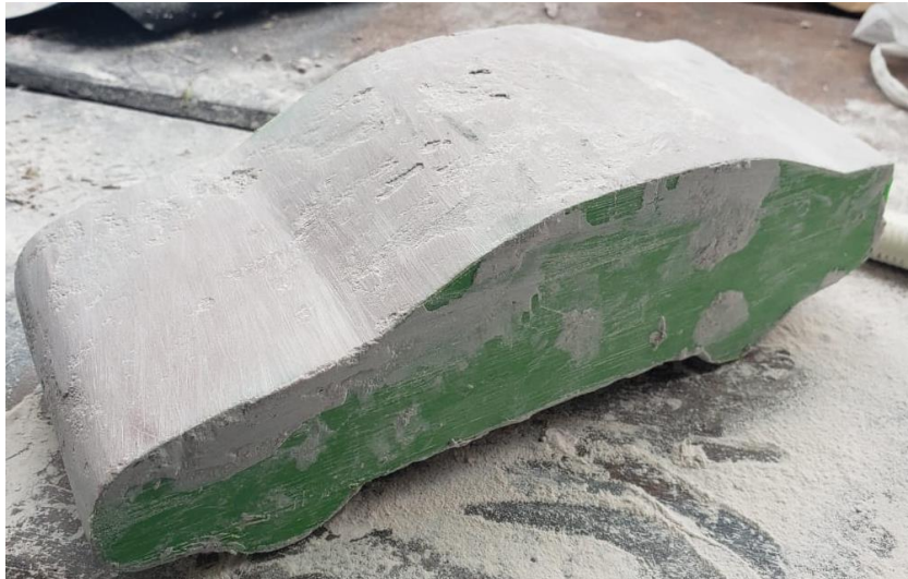
Figura 3-2 Recubrimiento de arcilla
