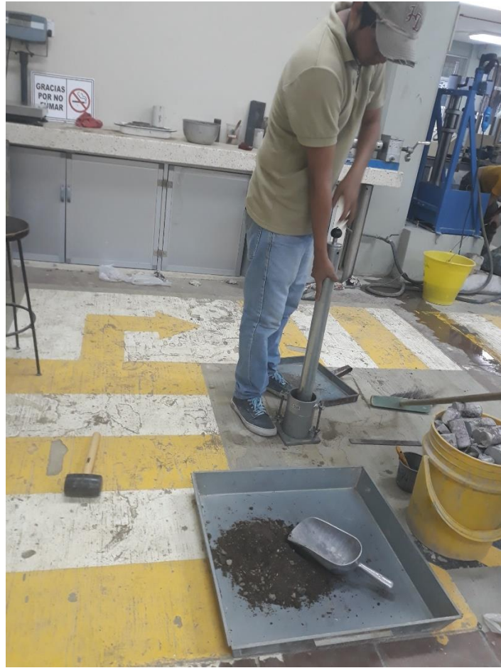
Anexo A9. Compactación de muestras, Ensayo CBR.
