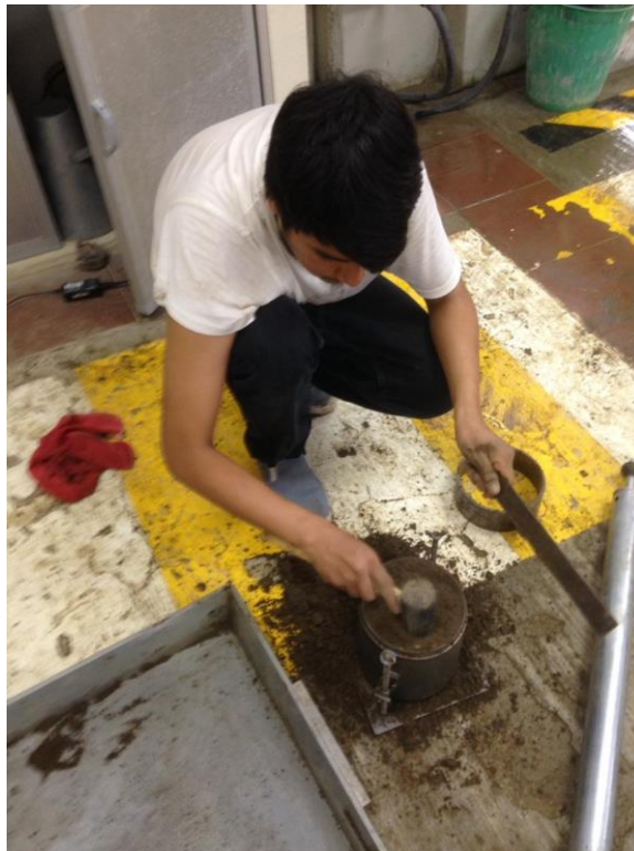
Anexo A8. Enrasamiento de muestra, Ensayo Proctor Modificado.
