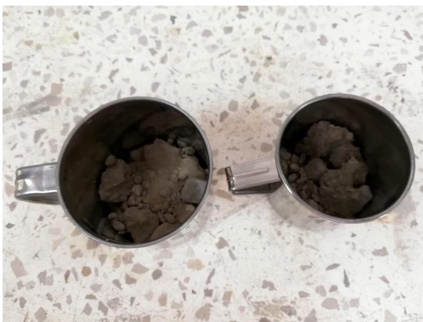
Anexo A11. Preparación de muestras para secado en horno.
