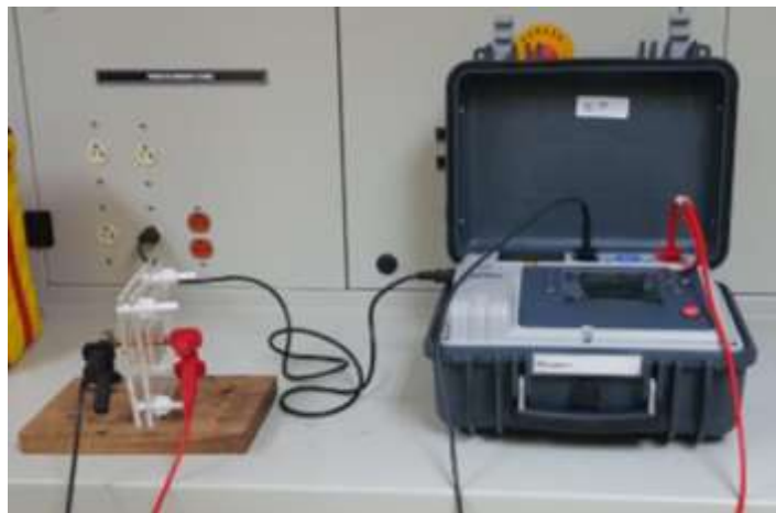
Figura 2.3 Sistema eléctrico para ensayos de resistencia eléctrica
