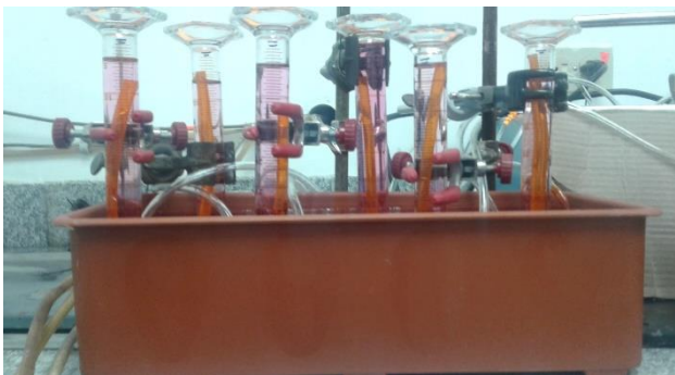
Figura B.3 Sistema de medición de biogás generado
