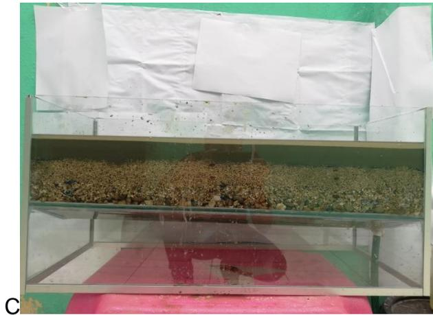
**Figura 2.10 Disposición del lodo en el lecho de secado (día 0). Fuente: Autores.**
