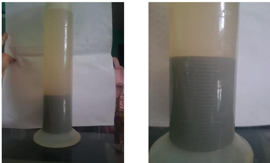
**Figura 2.3 Prueba de compactación a través del tiempo. Fuente: Autores.**
