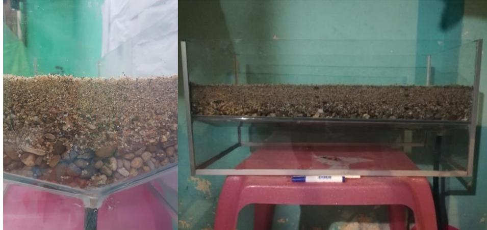
**Figura 2.8 Colocación de la capa de arena en el lecho de secado. Fuente: Autores.**
