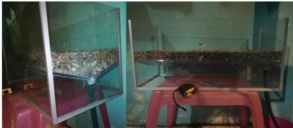
Figura 2.7 Colocación de la capa de gravilla en el lecho de secado. Fuente: Autores.
