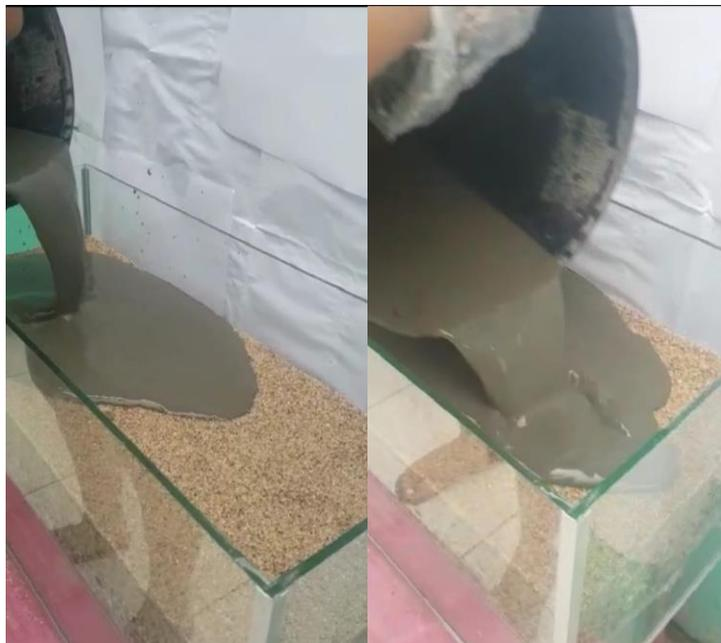
**Figura 2.9 Colocación de la capa de lodo en el lecho de secado. Fuente: Autores.**
