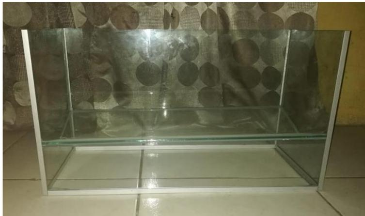
**Figura 2.2 Lecho de secado piloto. Fuente: Autores.**
