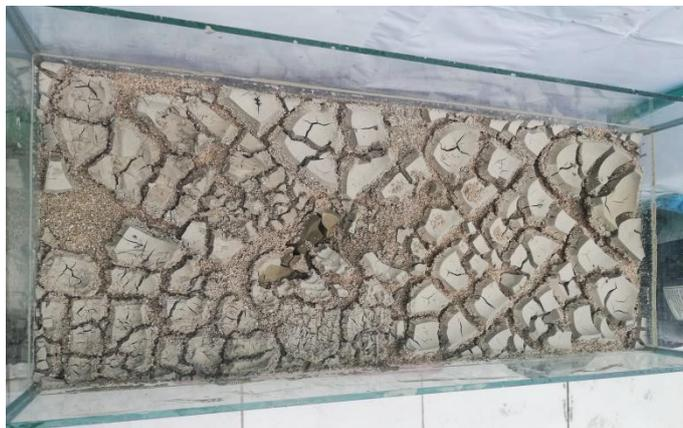
**Figura 2.12 Disposición del lodo en el lecho de secado (día 9). Fuente: Autores.**
