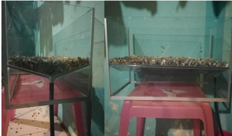
Figura 2.6 Colocación de la capa de grava en el lecho de secado. Fuente: Autores.
