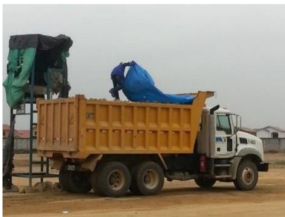
Figura 12. Ingreso de volquetas y control de uso de lona en Balde.
