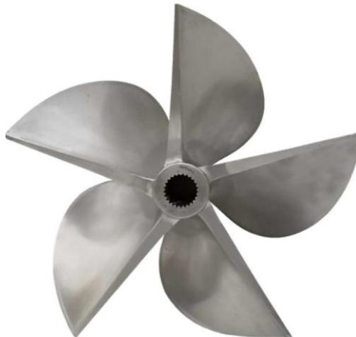
**Figura 1.6 Hélice tipo "Surface Piercing" de 5 aspas [9]**
