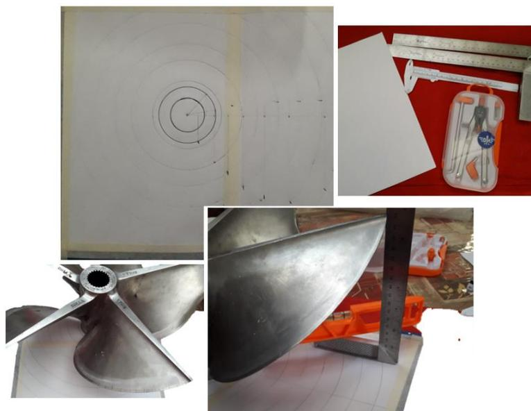
**Figura 2.24 Implementos para obtener la geometría de la hélice**
