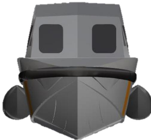
**Figura 2.6 Vista en planta - frontal Perfil del casco de la lancha Interceptora.**
