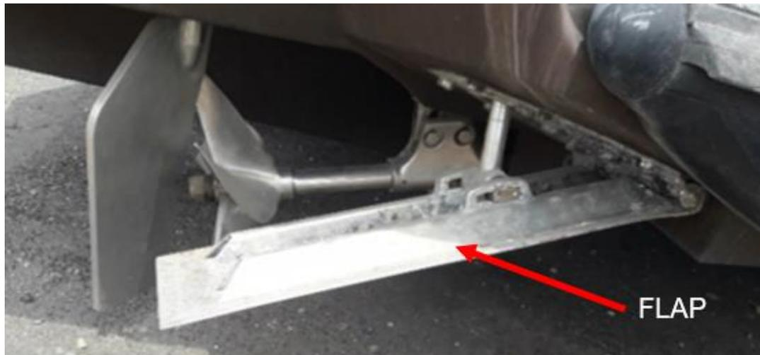
**Figura 2.8 Flaps instalados en la lancha Interceptora.**
