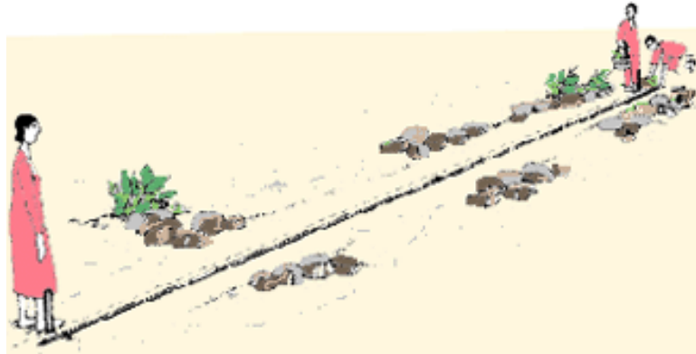
Fig. 2.5 Método de medición directa (FAO) Mediante cuerda segmentada se midió el perímetro del espacio disponible en Diakonía
