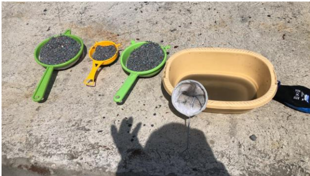
Toma de muestras para ensayo de granulometría
