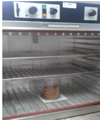
Figura 2.8 Filtrado resultante en estufa
