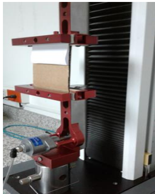
Figura 2.26 Colocación de muestra en equipo (Dinamómetro)
