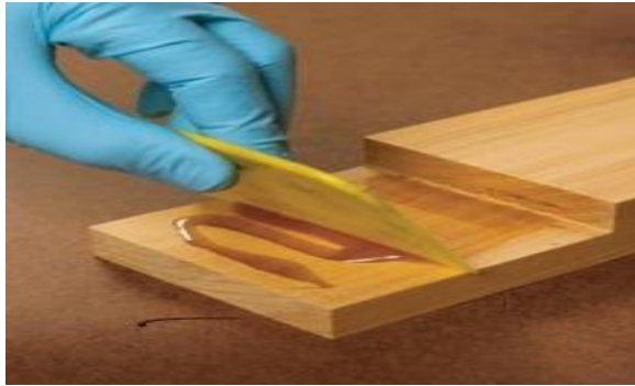
Figura 1.22 Adhesivo de poliuretano en construcción de puertas
