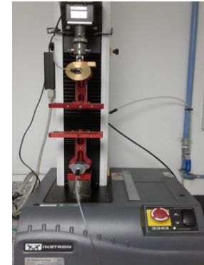
Figura 2.25 Equipo (Dinamómetro) para medir la fuerza de peel
