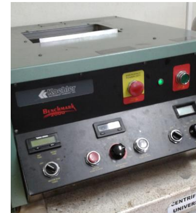
Figura 2.10 Equipo centrifuga universal
