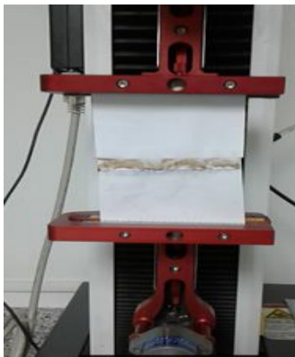
Figura 2.20 Colocación de muestra en equipo (Dinamómetro)
