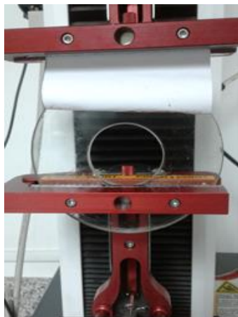
Figura 2.32 Proceso de despegue de los materiales papel – acrílico
