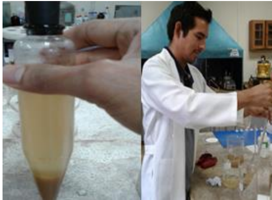
Figura 2.11 Obtención del sobrenadante y eliminación del sedimento
