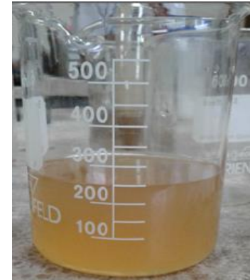
Figura 2.13 Precipitación del adhesivo con etanol 96%
