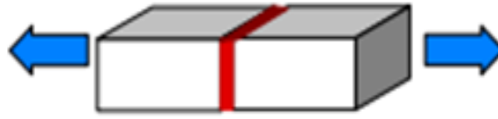
Figura 1.32 Unión adhesiva por ensayo de tracción
