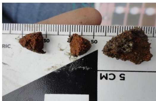
Figura 4.26. Nódulos de limo oxidados.
