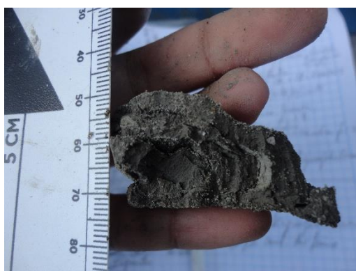
Figura 4.52. Limo con intercapas de arena, plegadas.
