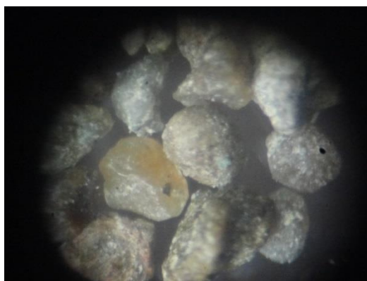
Figura 4.7. Minerales de Feldespatos, P6. Foto realizada desde el estéreo microscopio manual, Vista desde el lente.
