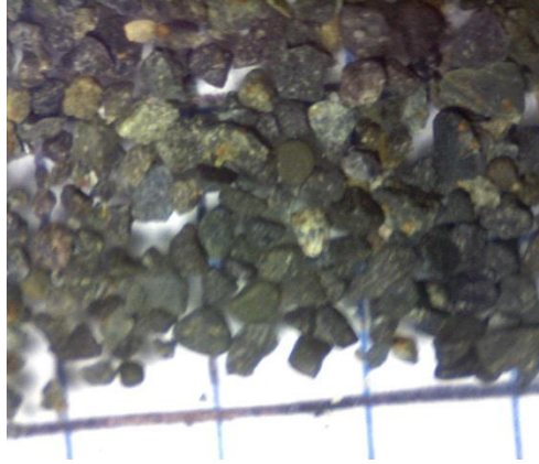
Figura 4.3. Minerales de Anfíboles/olivinos/piroxenos, P4. Foto realizada desde el estéreo microscopio digital.
