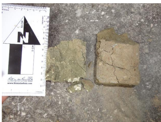
Figura 4.43. Semiroca con nódulos calcáreos.
