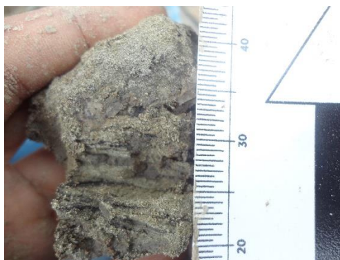
Figura 4.45. Limo con intercapas de arena y lignito.
