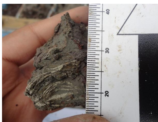
Figura 4.63. Limo con intercapas de arena.
