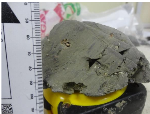
Figura 4.35. Arcilla con nódulos calcáreos.
