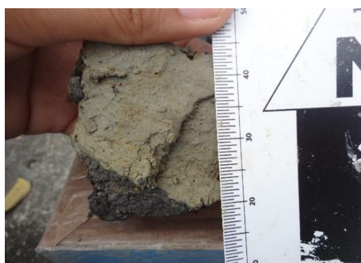
Figura 4.27. Limo muy plástico con lignito.
