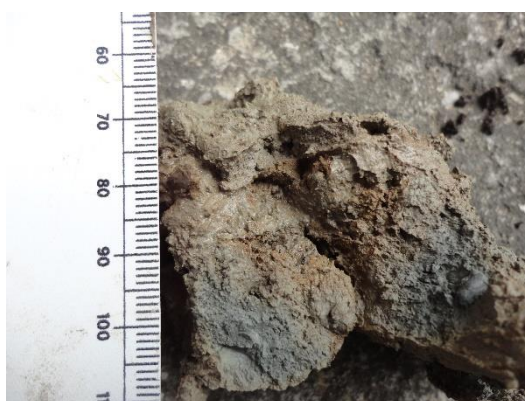
Figura 4.30. Limo con arena y nódulos oxidados.
