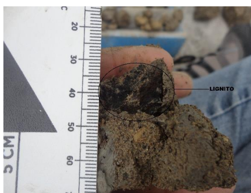
Figura 4.50. Limo con arena y lignito.
