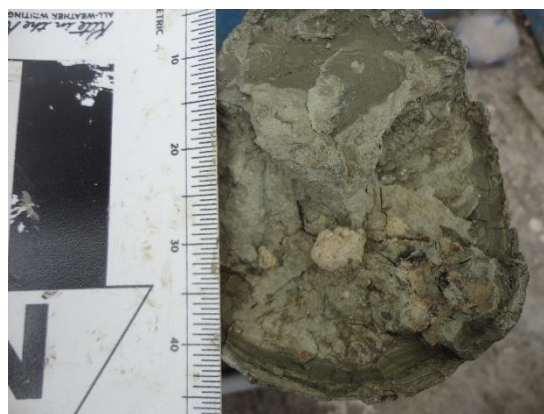
Figura 4.62. Arcilla con nódulos calcáreos.
