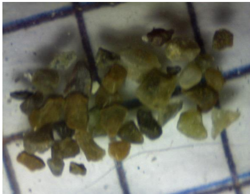
Figura 4.4. Minerales de Feldespatos, P4. Foto realizada desde el estéreo microscopio digital.
