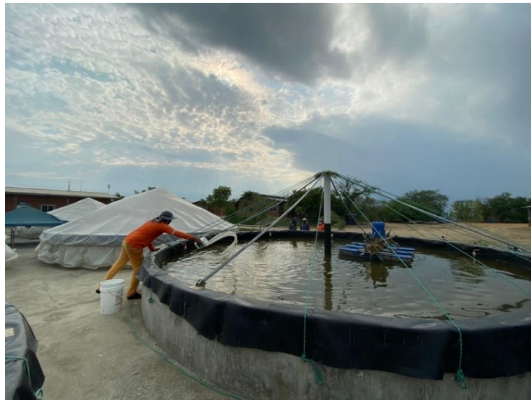
Figura 2. 5 Boleo de la mezcla de meta bisulfito de sodio y cloruro de cobalto sobre el volumen de agua del raceway. Fuente: (Echeverría, 2021)
