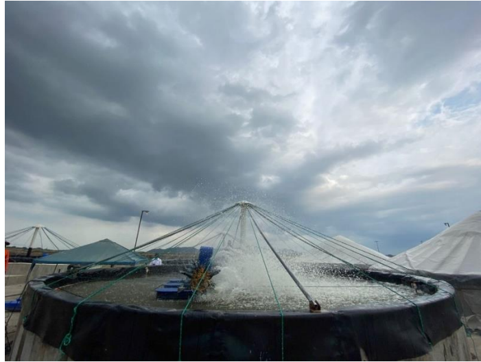
Figura 2. 7 Aireador eléctrico de 8 paletas de 1.5 hp en un raceway de 50 m 3 con 30 m 3 .de agua. Fuente: (Echeverría, 2021)
