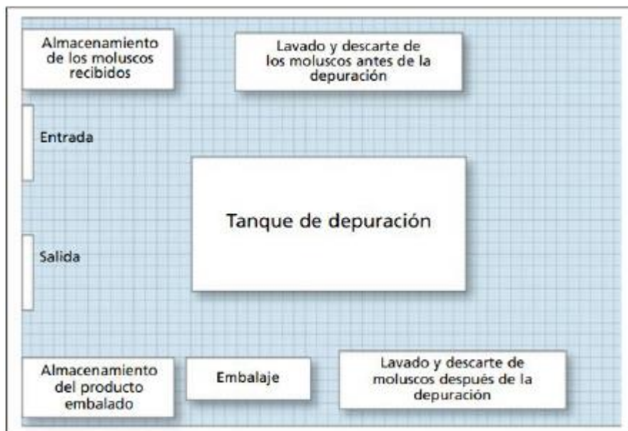
Ilustración 3.3 Instalaciones del sistema de depuración de bivalvos
