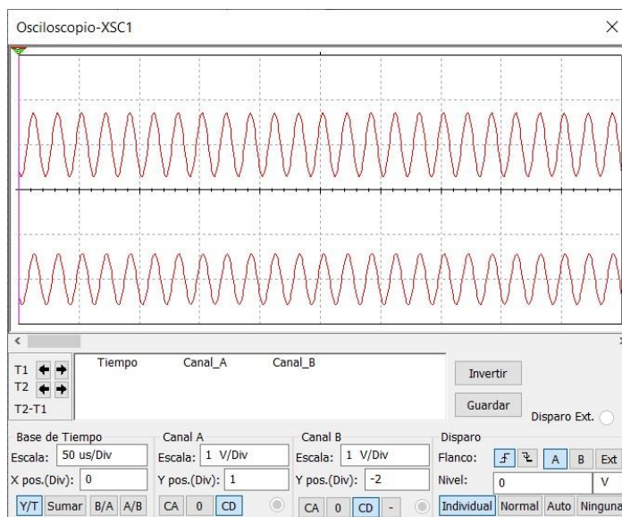
Figura 3.23. Voltaje del oscilador y en la carga. (Fuente autor)
