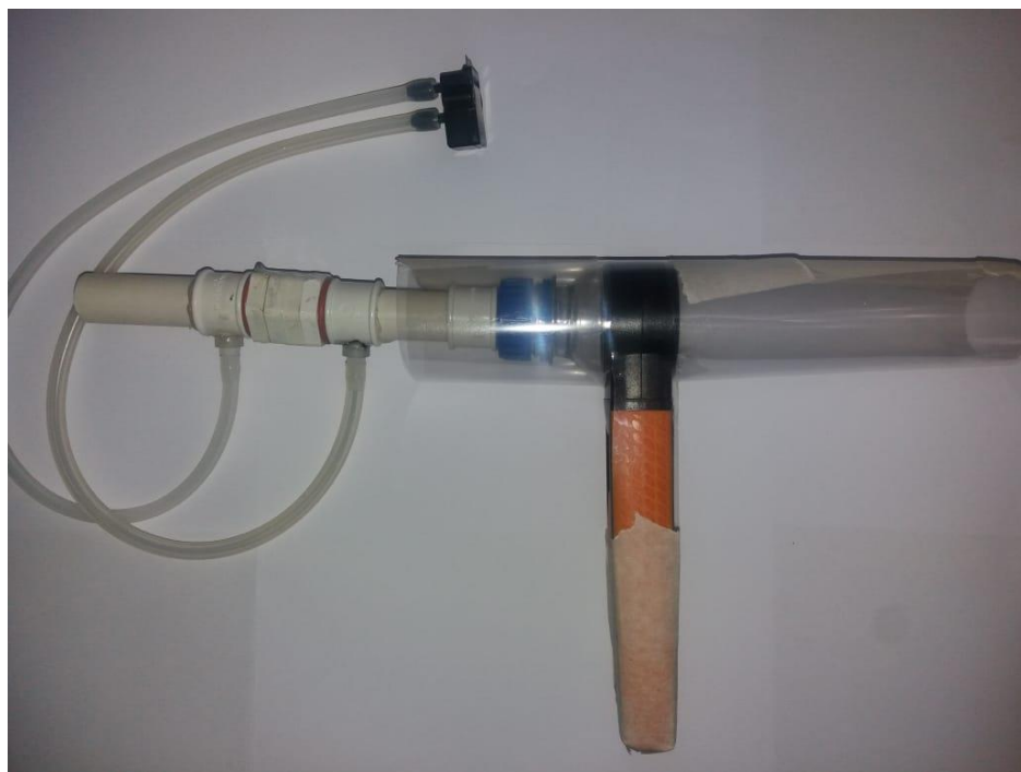
Figura 4.15. Acoplamiento entre el anemómetro y el neumotacógrafo. (Fuente autor)
