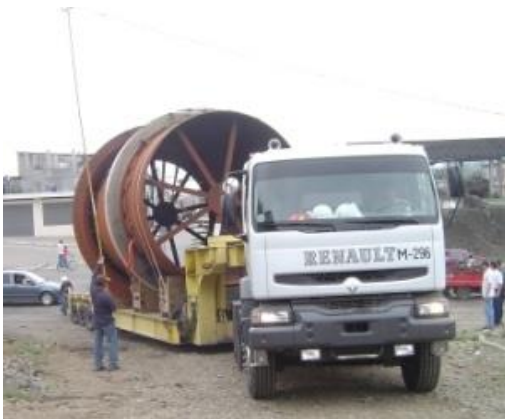
Transporte de tramo de horno giratorio
