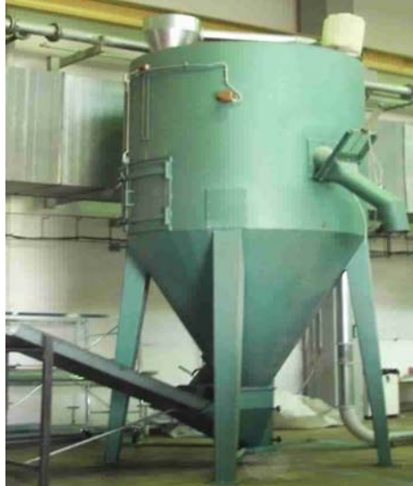
Figura 5: Silo de Almacenamiento
