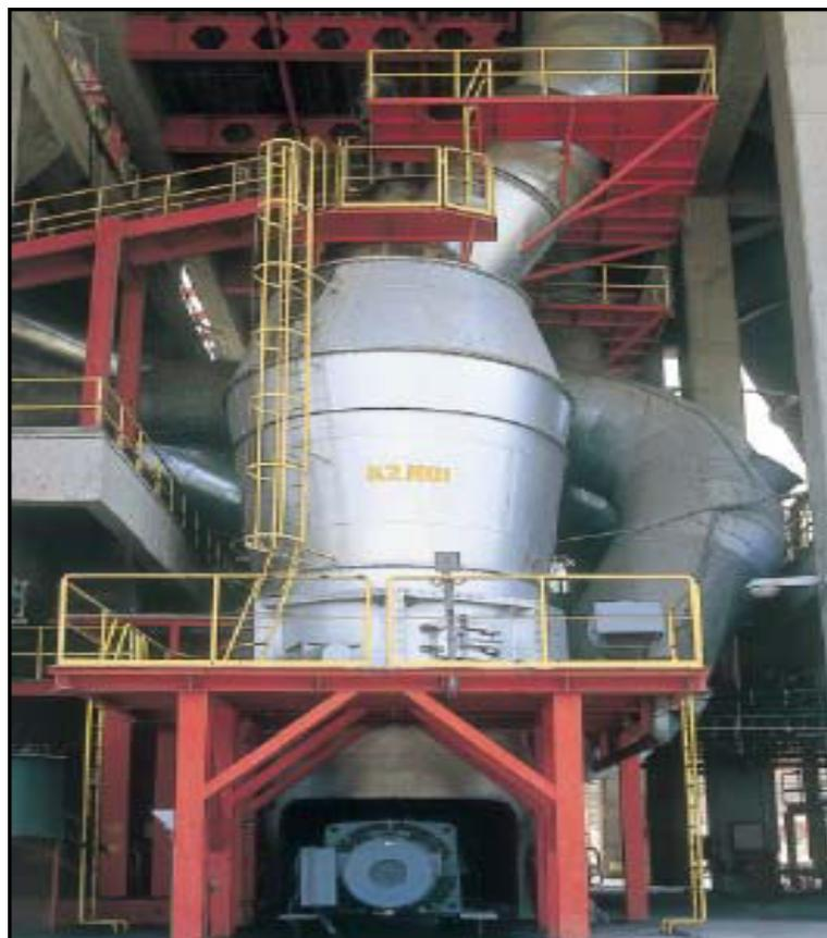
**FIGURA 2.5. MOLINO DE RODILLOS EN INSTALACIÓN [5].**
