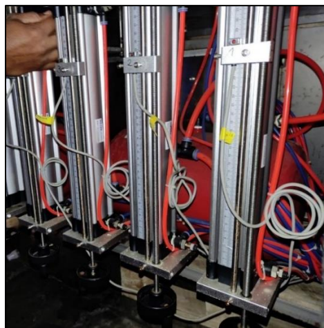
Figura 1.4. Sistema de calibración de volumen de máquina dosificadora de cliente
