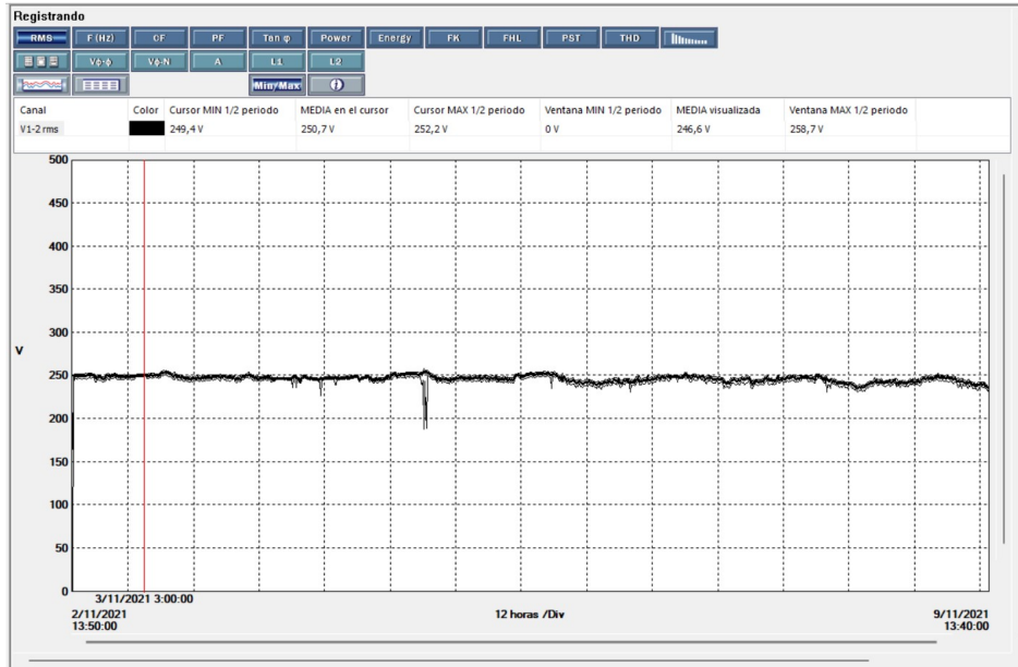
Figura 3.6 – Pantalla de monitoreo de tensión línea-línea (V1-2).
