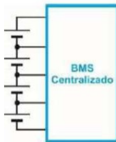
Figura 2.21 – Diagrama arquitectura centralizada. Fuente: [Valencia y Grisales, 2017].
