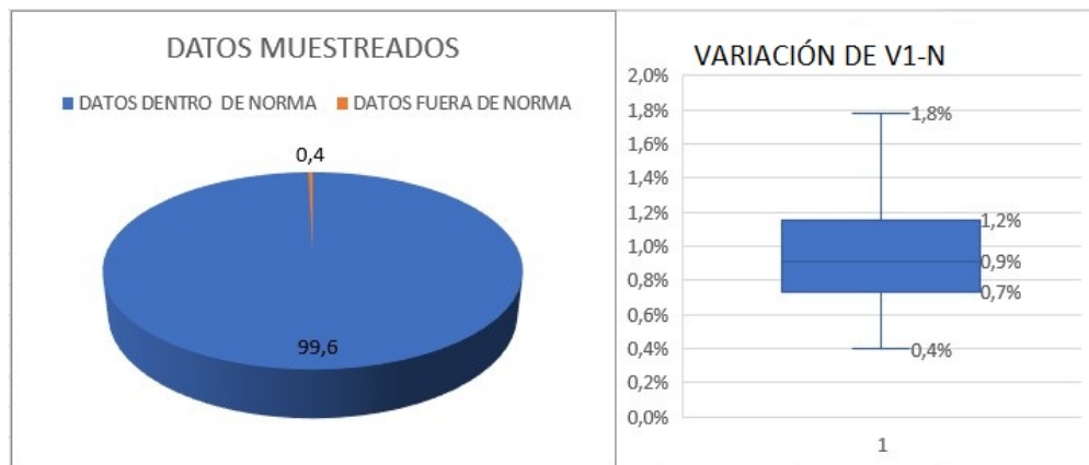
Figura 3.34 – Datos muestreados y diagrama de bloque de la variación de tensión línea 1 - neutro (V1-N).
