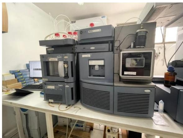
**Gráfico 2.2** Equipo de cromatografía líquida acoplado con espectrometría de masas
