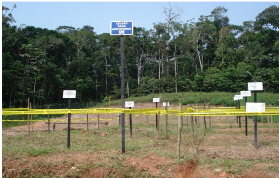
Grafico 3.14. Celdas ya taponadas y marcadas
