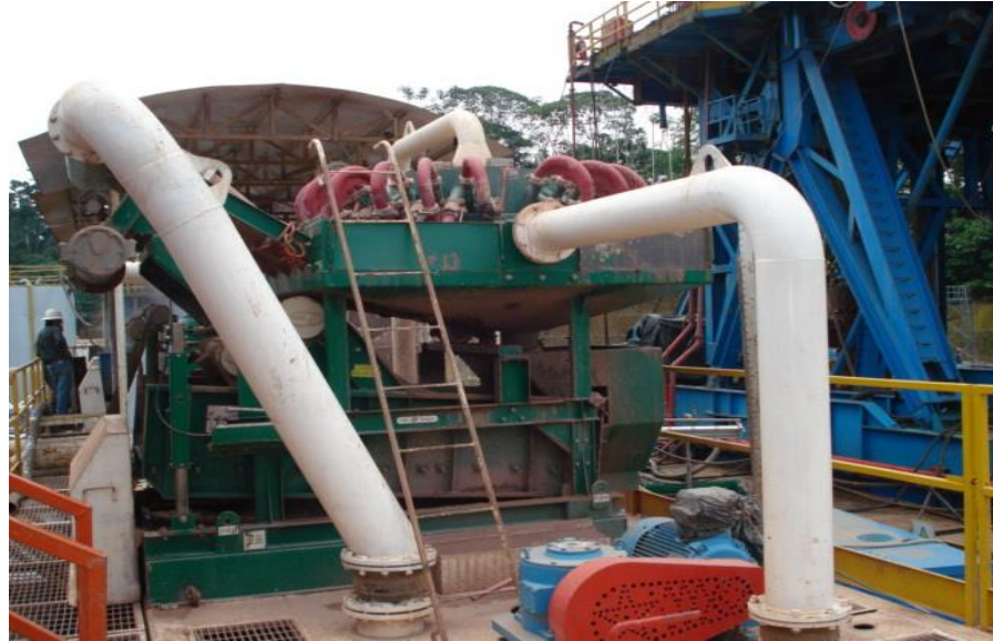
Grafico 3.4. Zaranda con el equipo completo trampa de arena
