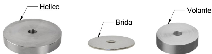
Figura 2.5 Discos de acero inoxidable usados para representar las cargas externas
