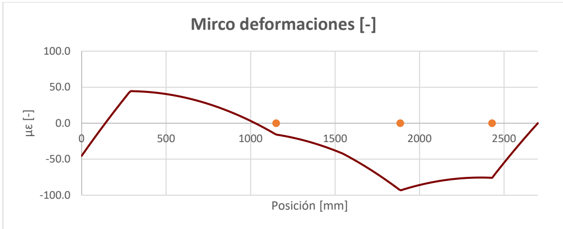
Figura B.2 Micro deformaciones a lo largo del eje
