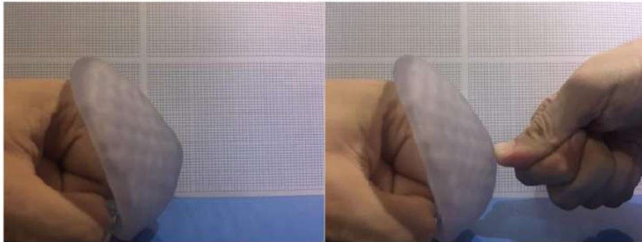
Figura 3.19 Evaluación de prótesis impresa en resina 80A con 20% de relleno, 5mm de espesor en cara frontal y giroide de 15 mm. Presenta una deformación de 5mm aproximadamente.
