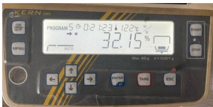
Figura 2.5 Medición del porcentaje de humedad
