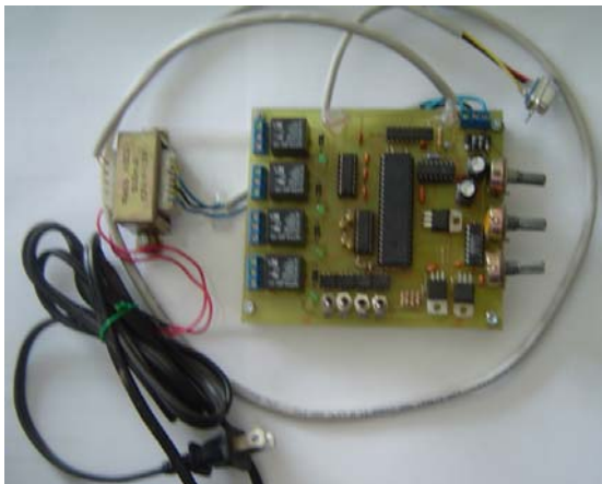
FIGURA 5 Vista superior de la tarjeta de adquisición.
