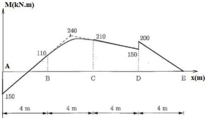
a) Dibuje el diagrama de fuerza cortante correspondiente (diagrama  $V$  vs  $x$ ) utilizando los signos de deformación correctos. Mencione todos los valores relevantes.
