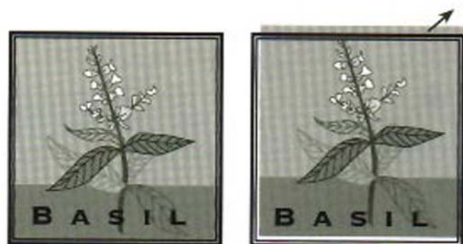
Fig. 4 – 131 Falta de Registro
