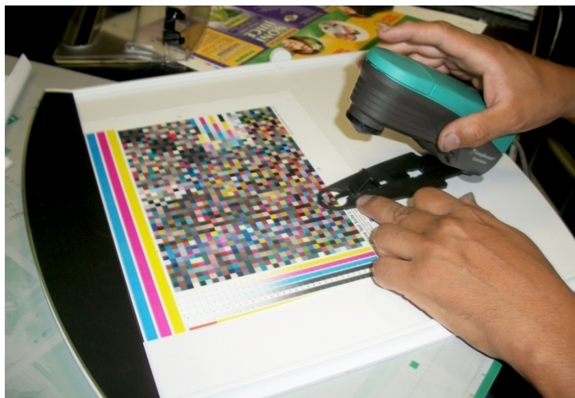
Fig. 4 – 92 Medición de los parches de color con espectrofotómetro
