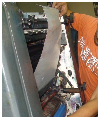
Fig. 4 – 85 Ubicación de plancha en rodillo
