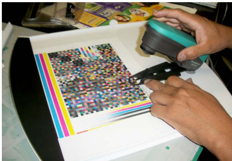
Fig. 4 – 67 Medición del IT8 con el Espectrofotometro
