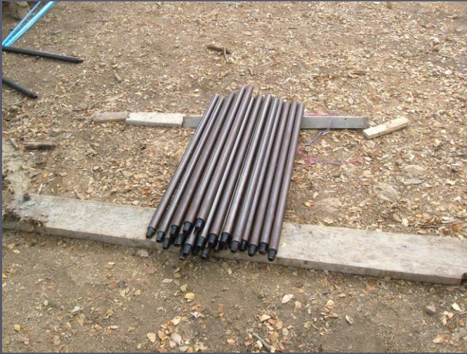
Barras Ew de 1m de longitud; Unión cónica y con un área de 2.55 cm 2 .
