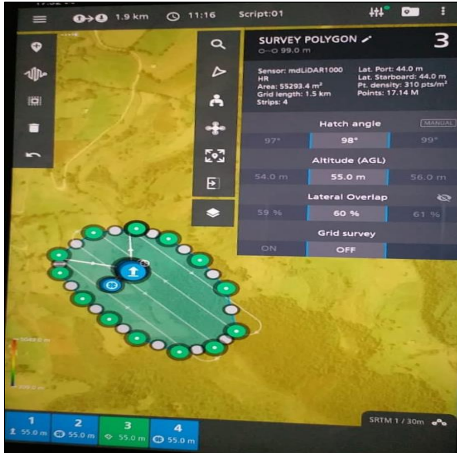
Ilustración 1.5 - Plan del vuelo del dron para el relevamiento del Pukará de Cullún
