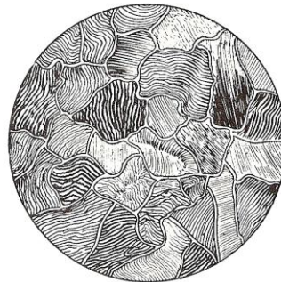
Acero con un contenido mayor al 0.83% de carbono, su estructura está compuesta de perlita rodeada de carburo de hierro
