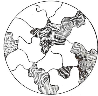
Acero con contenido de carbono menor al 0.83%, su estructura es compuesta entre ferrita y perlita
