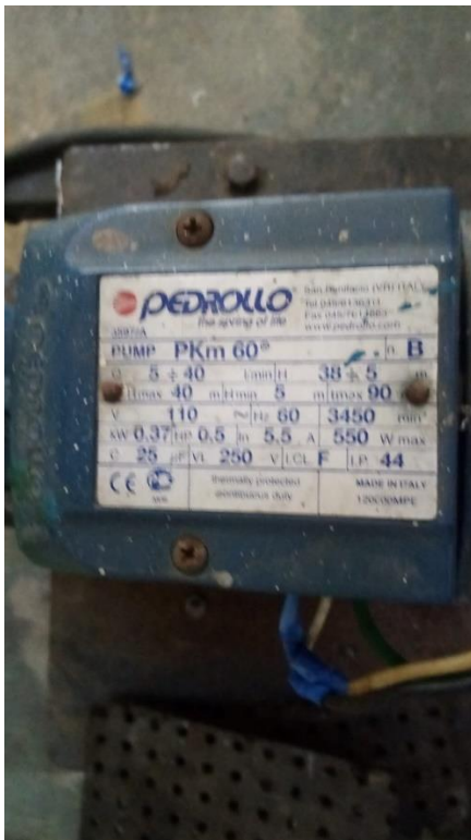
Figura 21. Instalación de la nueva bomba PKm60 para trabajo a alta temperatura
