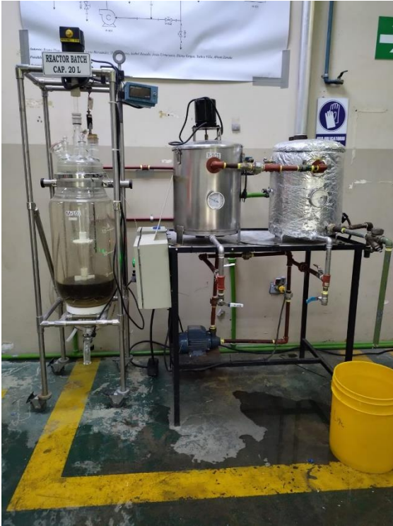
Figura 24. Reactor Batch 20 L con Sistema de calentamiento
