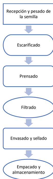
Figura 8 Diagrama del proceso de extracción de aceite de sachá inchi. Elaboración: Autor
