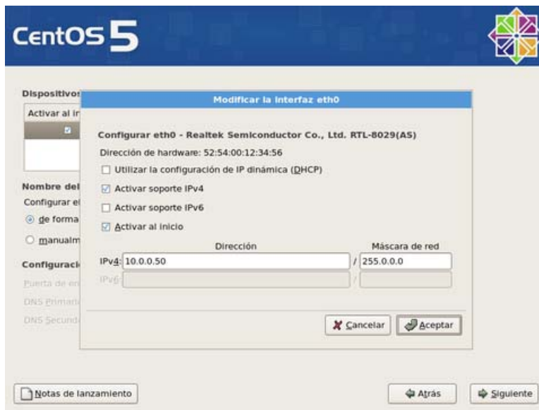
Fig. 10: Configuración de la red en Instalación de Centos 5
