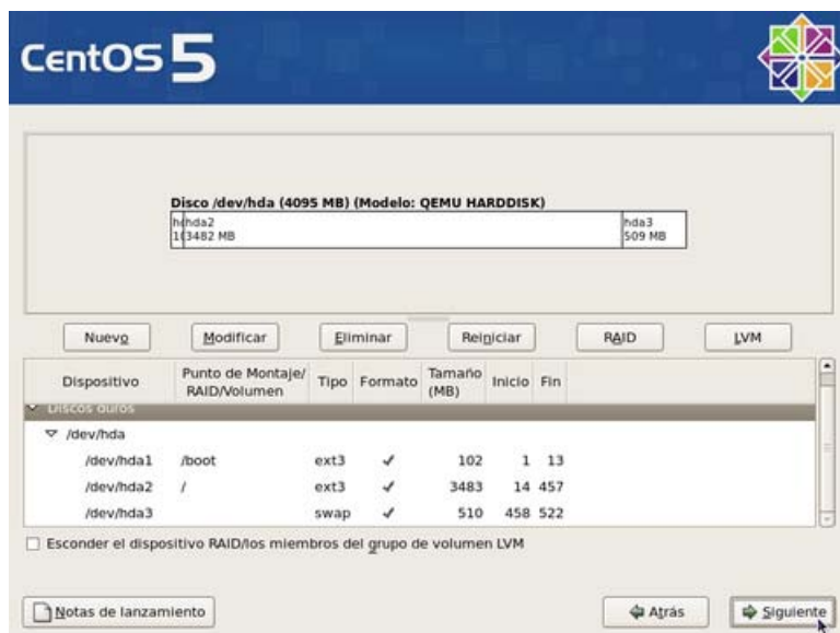
Fig. 8: Creación de Particiones en Instalación de Centos 5
