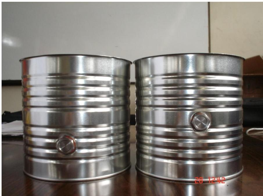
**FIGURA 2.2** Ubicación de los sensores en los envases para la determinación del punto crítico de calentamiento en el producto
