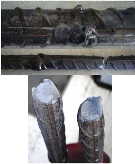
Figura. 3.10 Probeta 2, con electrodo E7018.
