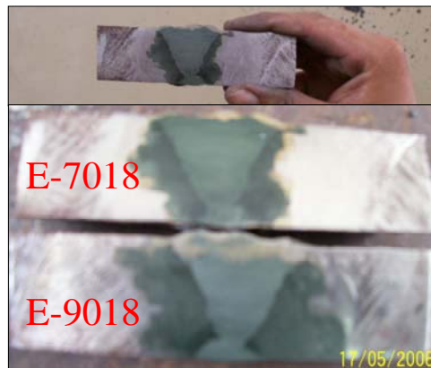
Figura. 3.8 Probetas para macroscopia.
