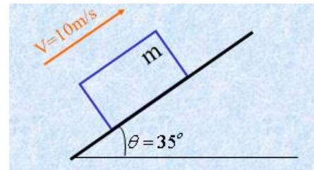
20. Un bloque de masa  $m = 1$  kg es lanzado sobre una superficie inclinada con una velocidad inicial de 10 m/s como se indica en la figura. Si el coeficiente de rozamiento cinético entre el bloque y el plano inclinado es 0.2, entonces el trabajo neto realizado sobre el bloque hasta que se detiene es:
