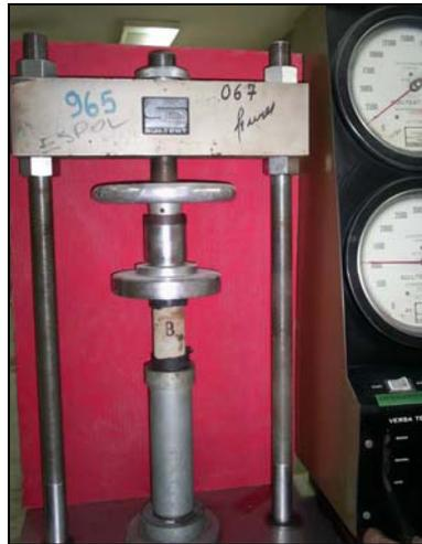
Figura 2.5.4 Ensayo de Compresión Simple
