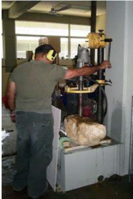
**Extracción de la muestra inalterada**
