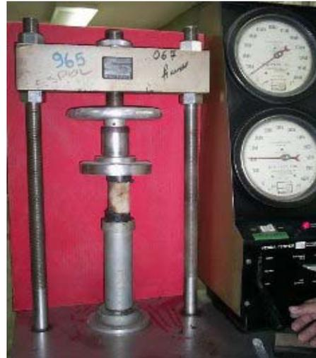
Prueba de Compresión Simple, Cilindro A y Cilindro C
