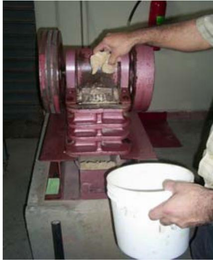
**Molienda del Material, Trituradora de Mandíbulas**
