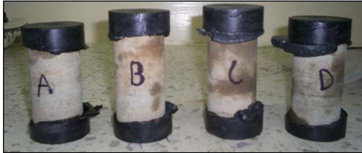
Figura 2.5.3 Testigos previo al ensayo de Compresión Simple
