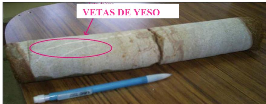
Figura 2.5.2 Imagen de un testigo extraído, nótese las vetas de yeso.
