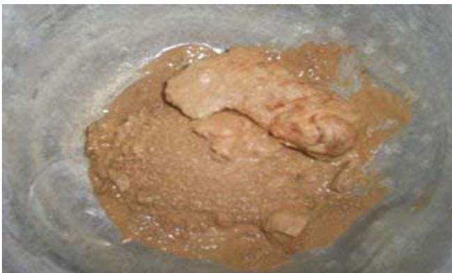
**Muestra de Lutita luego de extracción de Agua**
