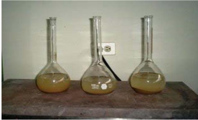
**Ensayo de Gravedad Especifica**
