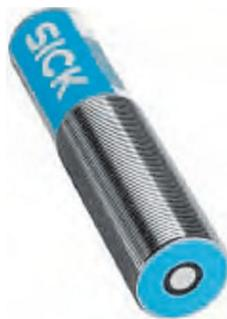
El Sensor ultrasónico marca sick modelo um30 13113, tiene un alcance de escaneo de 200 a 1300 mm con una frecuencia de 200Khz de transmisión y una resolución de 0.36mm con un tiempo de respuesta 110 ms
