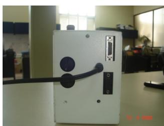
Segundo paso, se lleva a cabo en el sitio donde se realizará el monitoreo; se debe colocar el DustScan dentro del Sentinel, para realizar este paso debe verificar que el DustScan este sujeto al Sentinel a través de un tornillo el cual se atornilla por la parte inferior del DustScan, con esta acción se asegura que el orificio de salida del aire muestreado del DustScan este a la misma altura del orificio de purga del Sentinel.
