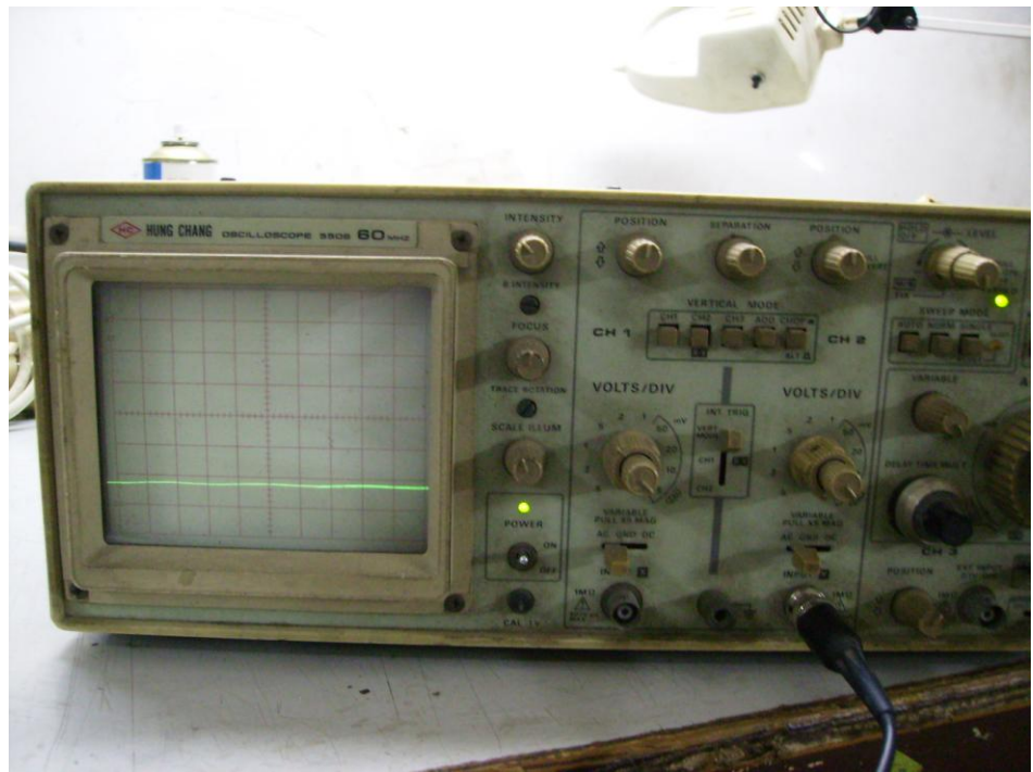
Figura 3.5.-Oscilo grama del rizado en V_o de la lámpara de tungsteno.
