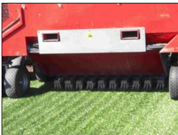
Figura N° 2.40 Cepillado y Fibrilación de césped sintético
