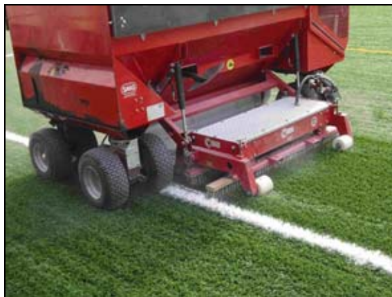
Figura N° 2.39 Riego de arena y caucho
