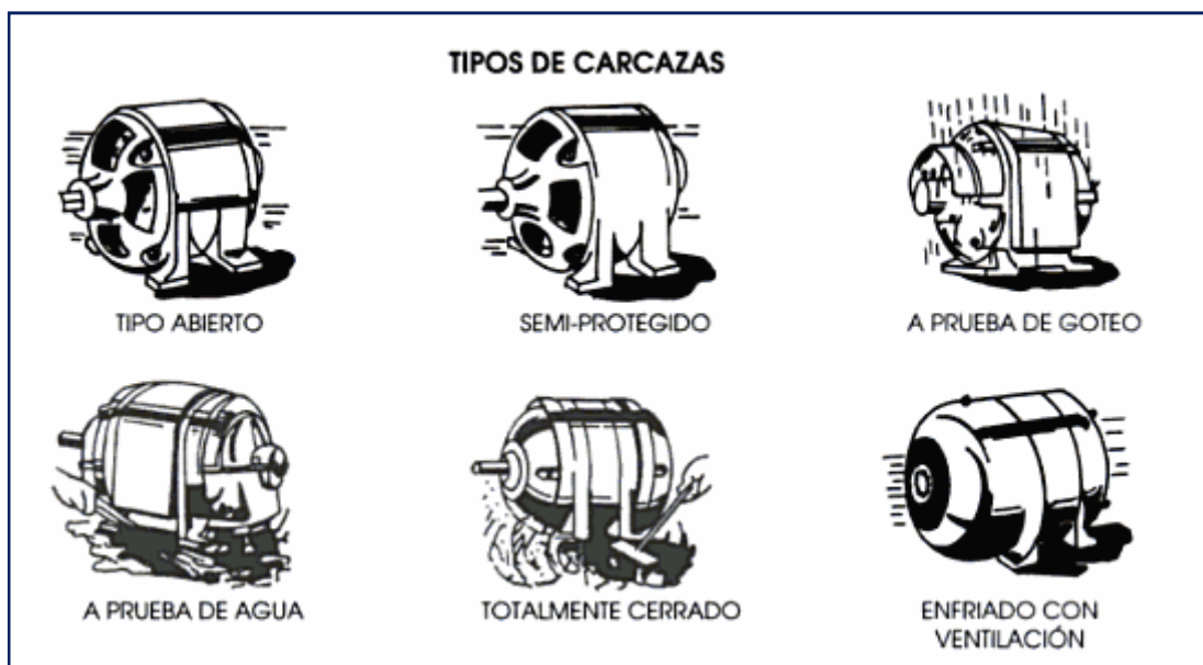
GRAFICO 2.7: VARIAS CARCASAS DE MOTORES ELECTRICOS
